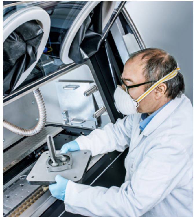
Innovatives Fertigungsverfahren: Das Laserschmelzen erlaubt die Produktion hochkomplexer metallischer Bauteile durch schichtweisen Aufbau des Werkstoffs.
